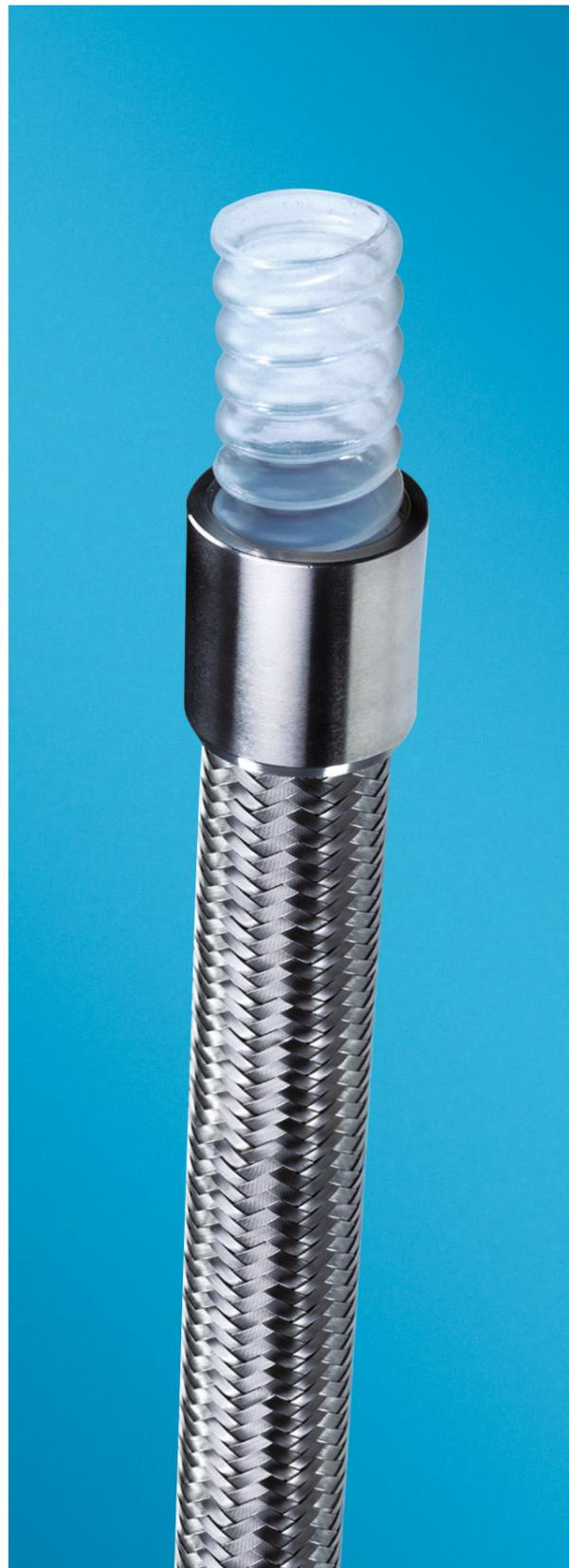
Für TECNOLINE V/SS und V/AS/SS entnehmen Sie bitte die Arbeitsdrücke aus der Tabelle. Dabei ist zu beachten, dass diese Werte nur bis zu einer Temperatur von max. +130 °C zugelassen sind. Über diese Temperatur hinaus reduziert sich der max. Arbeitsdruck um jeweils 1% für 1 °C.
