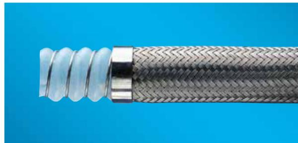
Seewasser zu der sogenannten Chlorspannungskorrosion des Edelstahlgeflechts. Für solche Anwendungen werden die KYB-Ausführung oder aber ein Hastelloy-C276-Drahtgeflechte (siehe Seite 8) empfohlen, wobei die Medientemperatur nicht 60°C übersteigen darf.
